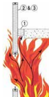
延缓火势蔓延 (使用 Thermafiber® 岩棉防护)
